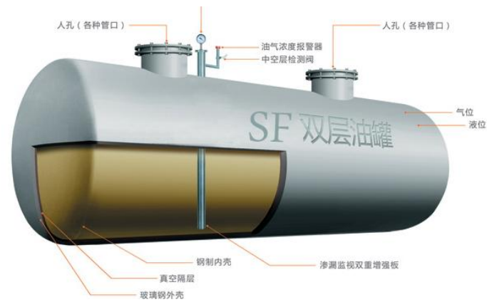
钢-玻璃纤维增强塑料双层储罐
