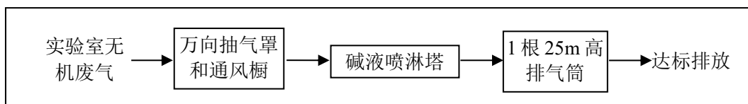
图4-1 项目实验室无机废气处理工艺流程图
