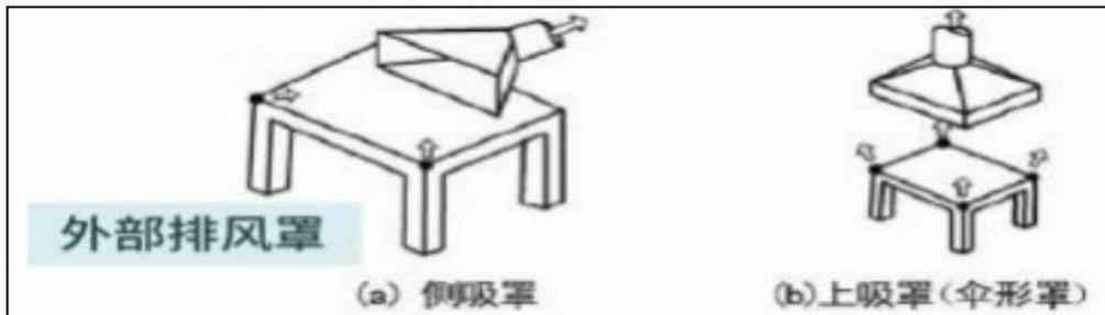
项目投料、密炼、开炼、造粒、发泡、烘干工序产生的废气收集罩采用排风罩的上吸罩，且在集气罩下方安装软帘，确保集气罩应尽可能靠近有害物发散源，尽可能将污染源包围起来，使污染物的扩散限值在最小的范围内，以便防止横向气流的干扰，减少排气量。上吸罩的罩口大小大于有害物、及粉尘扩散区的水平投影面积；罩口与罩体联接管面积不超过 16: 1，排风罩扩张角要求  $45^{\circ}\sim 60^{\circ}$ ，最大不宜超过  $90^{\circ}$ ，空间条件允许情况下应加装挡板。
