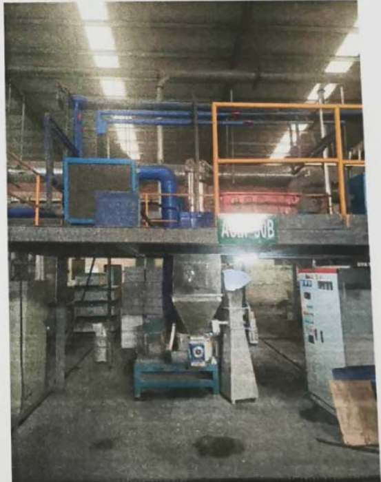
粗碎、粉碎工序密闭引出管道
